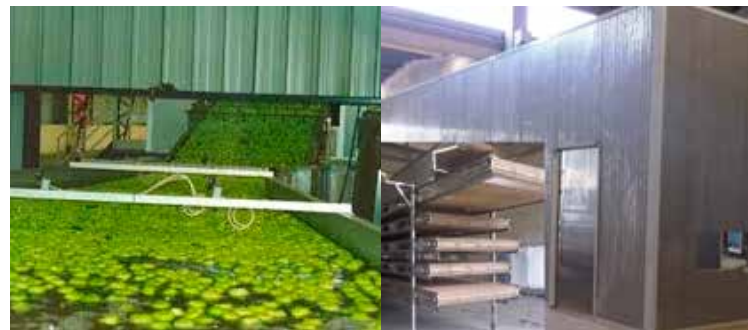
Figura 6. Un impianto di lavaggio di mele (a sinistra) ed un tunnel di asciugatura/essiccazione (a destra).
