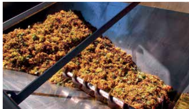
Figura 1. Ricevimento dell'uva in una vasca (tramoggia) di ricezione con coclea a spirale.
